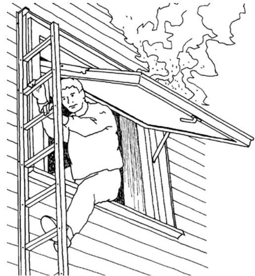
Fig. 1 Sørlandsstigen i bruk under rømming.
